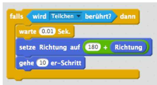
Abbildung 10: Block für das Abprallen des Moleküls am Teilchen. Es wechselt seine Richtung und entfernt sich vom Stoßpartner.
