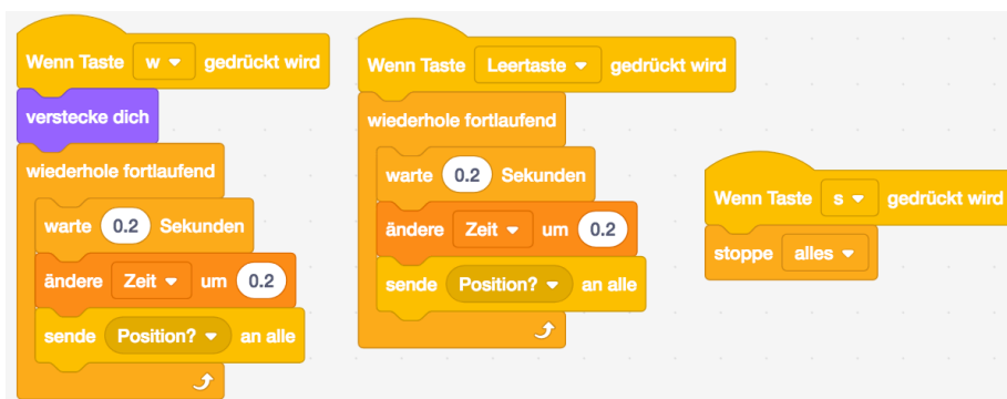
Abbildung 52: Programme der Figur Wand : Ergänzt wird eine Variable Zeit , die als Stoppuhr dient. Mit w wird sie erstmals ausgelöst, mit s gestoppt und mit Leertaste fortgesetzt.
