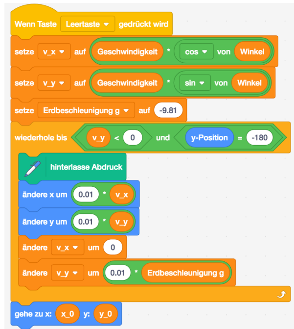
Abbildung 35: Programm für die Wurfbewegung. In einer kopfgesteuerten Schleife wird mit \Delta t = 0,01 die Wurfpardel berechnet, bis das Objekt mit negativer (vertikaler) Geschwindigkeit am Boden aufschlägt. Für die Bedingung \langle (y\text{-Position}) = -180 \rangle ist wichtig, dass das Zeitintervall \Delta t möglichst klein ist.
