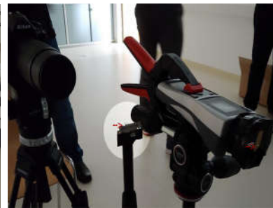
Versuchsaufbau mit einem Pappstreifen als Blende im Brennpunkt 2f (hell markiert), eine LED als Lichtquelle ist direkt rechts daneben (Mohn, Williams 2020)
