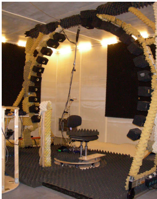
Loudspeaker Array for HRTF measurements (Acoustics Research Institute (ARI), Austrian Academy of Sciences) 用于 HRTF 测量的扬声器阵列 (奥地利科学院声学研究所 (ARI))
