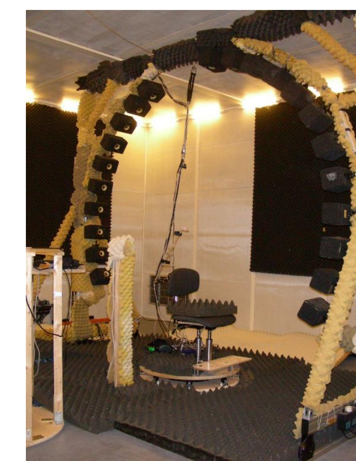
Lokalisationstest im reflexionsarmen Raum am ISF (Webseite ISF, https://www.kfs.oeaw.ac.at/ ).
