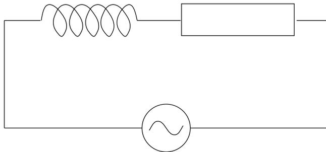
Das Verhalten linearer Systeme unter periodischer Anregung kann ebenfalls mit Hilfe von Fourier-Reihen untersucht werden. Als einfachstes Beispiel betrachten wir einen elektrischen Schaltkreis, bestehend aus einer Induktivität  $L$ , einem Widerstand  $R$  und einer Spannungsquelle  $U(t)$ . Der Strom  $I(t)$  in diesem  $RL$ -Kreis gehorcht der Differentialgleichung
