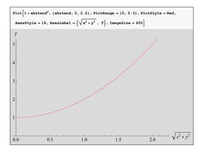
Wärmeausdehnung: 1 Wanzenmeter hat bei der Temperatur T die Länge (einfaches Modell)
